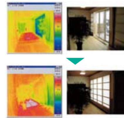
既存部分の縁側の大きなサッシに、断熱障子をつけました。熱画像で証明出来ている通り、断熱障子の性能が発揮されています。
