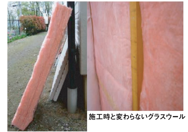
取り出して立て掛けて、剛性を確認 ▶ 経年変化による弾力の低下はみられない
