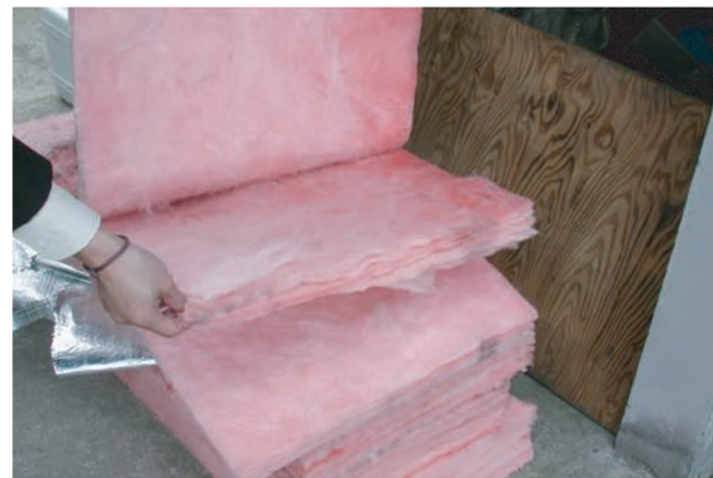
グラスウールをめくってみると内部は全く損傷無く、正常な状態を保っていた
