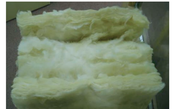
グラスウールを割ってみる ▶ 内部も外側同様の美しさで、完全な乾燥状態
