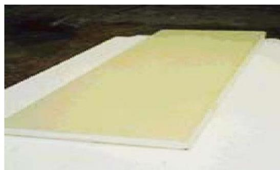
【写真-1】 サンドイッチパネルの例1
